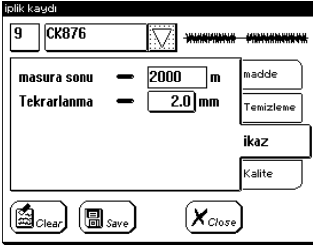
Şekil 37: Alarm denetim paneli
